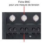
Vis M3 pour une mesure de température ‡ Les deux types de connexion sont disponibles pour chacune des voies
