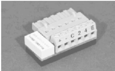
Ce module peut mesurer les thermocouples ou 50 mV affecté au **canal 3** , le **canal 1** est connecté en interne à une sonde thermistor C pour mesurer l'ambiance afin d'assurer la compensation de la soudure froide .
