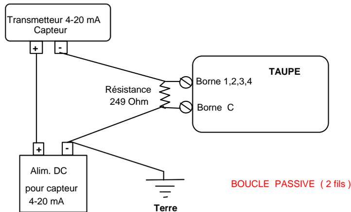
**Important !** Si la tension de votre Alim DC dépasse 18 V (par exemple 24 V) , il faut toujours garder la résistance 250 Ohm connectée pour éviter que le +24 V remonte jusqu'à l'appareil pouvant lui causer un dommage. En effet , avec la résistance connectée , le courant 20 mA génère une tension max de 5 V, par contre si déconnectée, votre capteur devient conducteur basse impédance et remonte le + de l'alim. à l'appareil.
