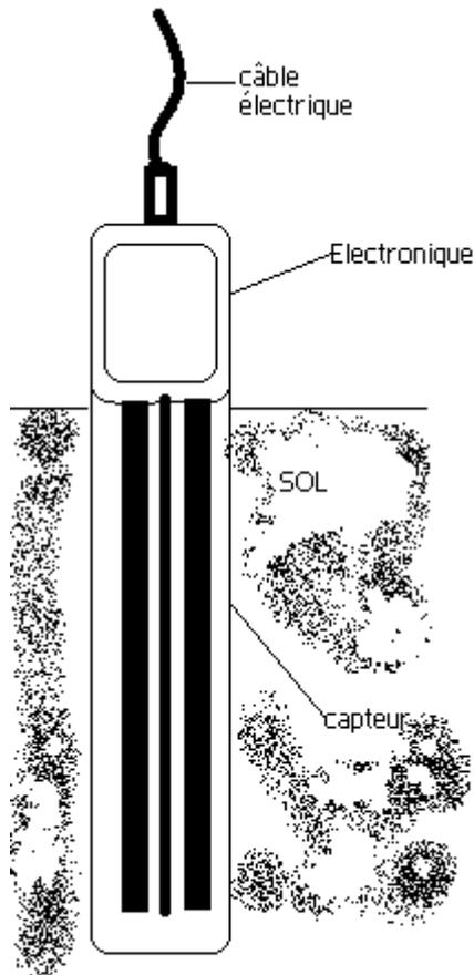
**Principe :** cette sonde mesure la constante diélectrique du sol pour en déduire le volume d'eau contenue. (mesure volumétrique)
